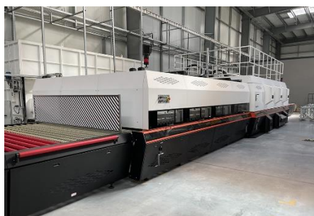
Nowoczesny i w pełni konwekcyjny piec do hartowania szkła
